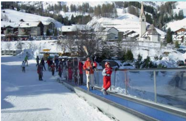
Förderband mit motorisiertem Handlauf – 1 200 000 transportierte Personen in der Wintersaison 2006/2007 (Arrabba – Italien).
