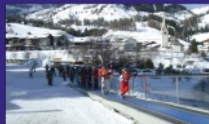
Förderband mit motorisiertem Handlauf—Arrabba
